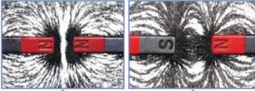
لاحظ ان برادة الحديد تكون على شكل خطوط منحنية مفتوحة عند تقريب قطبين مغناطيسيين متشابهين.
