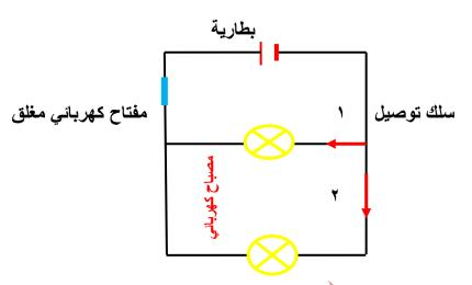
س // أتتبع مسار التيار الكهربائي في دارة كهربائية بسيطة موصولة على التوالى ؟
